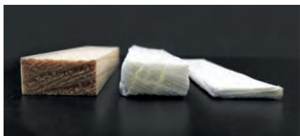
Durch die Entfernung des Lignins verliert das Holz seine Farbe. Nach dem Verdichten ist es dreimal stärker als das Ursprungsmaterial.
